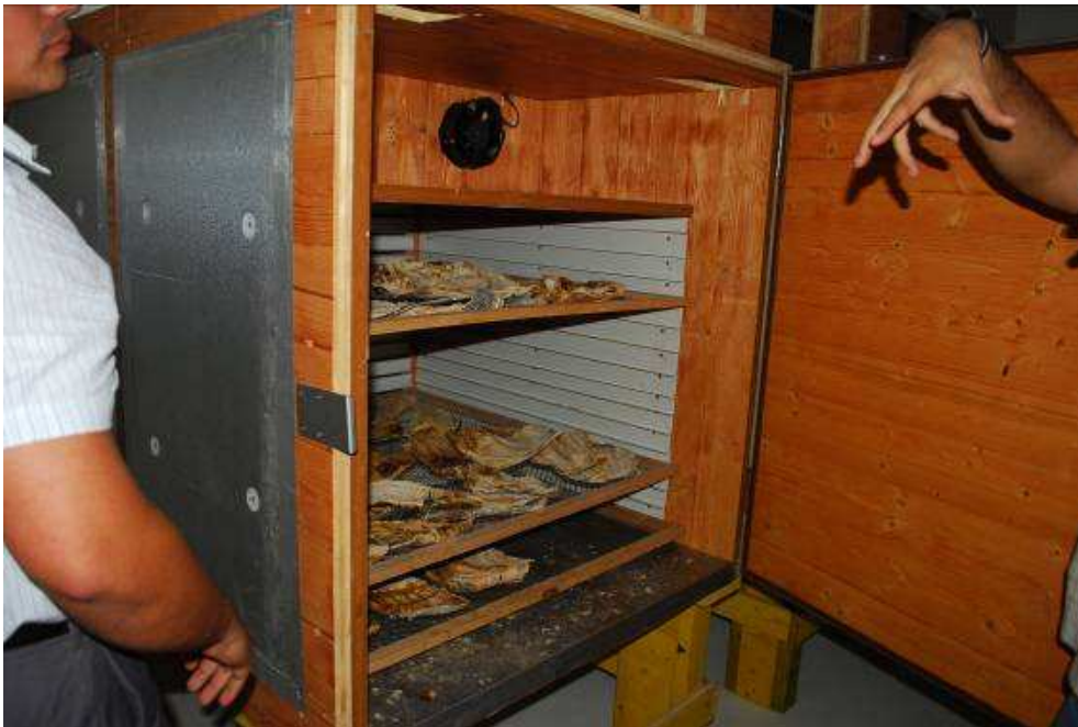
Foto 6: Interior de la planta de acopio y procesamiento Bocanalempa. Secadero de pescado.
